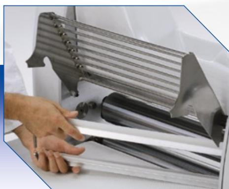
Raschiatori e supporti realizzati in polietilene e materiali alimentari di facile smontaggio e pulizia.
